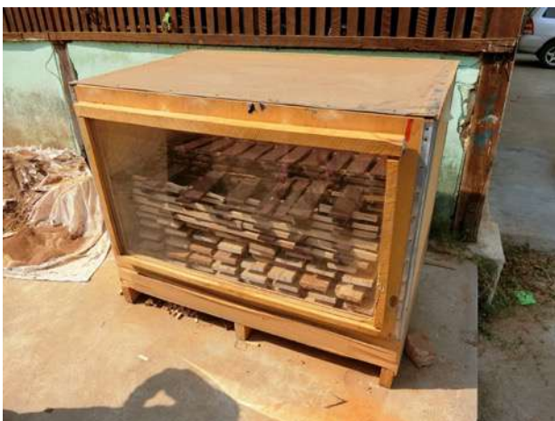
太陽熱を利用した改良版木材乾燥装置
