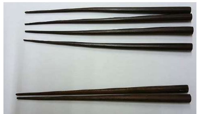
木材乾燥の導入による製品比較（写真上：導入前、同下：導入後）
